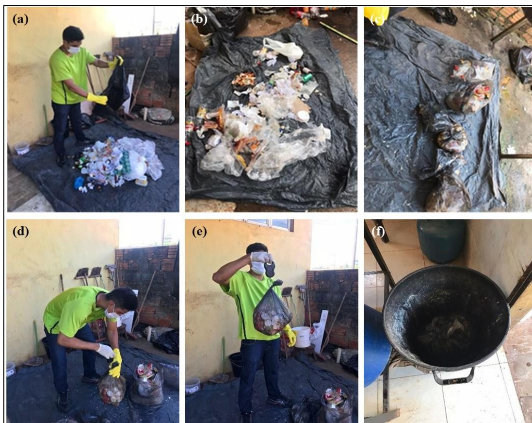
Figura 2: Obtenção da amostra final de resíduos. (a) Amostra de resíduos sobre a lona. (b) Segregação dos resíduos. (c) Resíduos separados por categorias. (d) – (e) Pesagem dos resíduos. (f) Descarte da amostra
